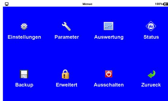
Die oberste Anzeigeebene des MPK ist das Messmenü. Bei ausgeschalteter Messung erscheint die Meldung „Keine Messung geplant“. Durch kurzes Betätigen des Feldes „Menü“ wird das Hauptmenü geöffnet, das folgende Untermenüpunkte enthält:
