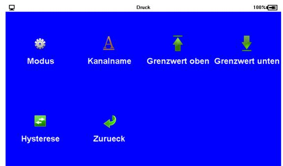
In darauf folgenden Optionsmenü können nun der Modus, Kanalname, Hysterese sowie beide Grenzwerte angepasst werden. Der Modus legt fest, ob der Kanal im Mess-Bildschirm angezeigt wird und ob die Messdaten dieses Kanals gespeichert werden sollen.
